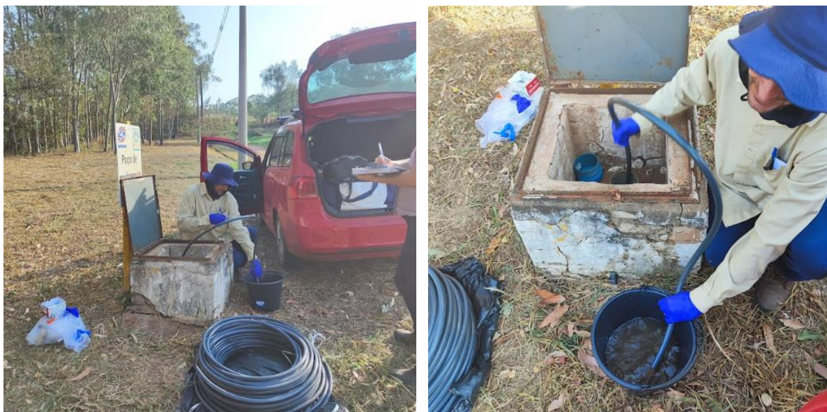
Figura 11: Desenvolvimento dos poços de monitoramento sendo realizados no Aterro de Bauru a partir do método de pistoneamento.
