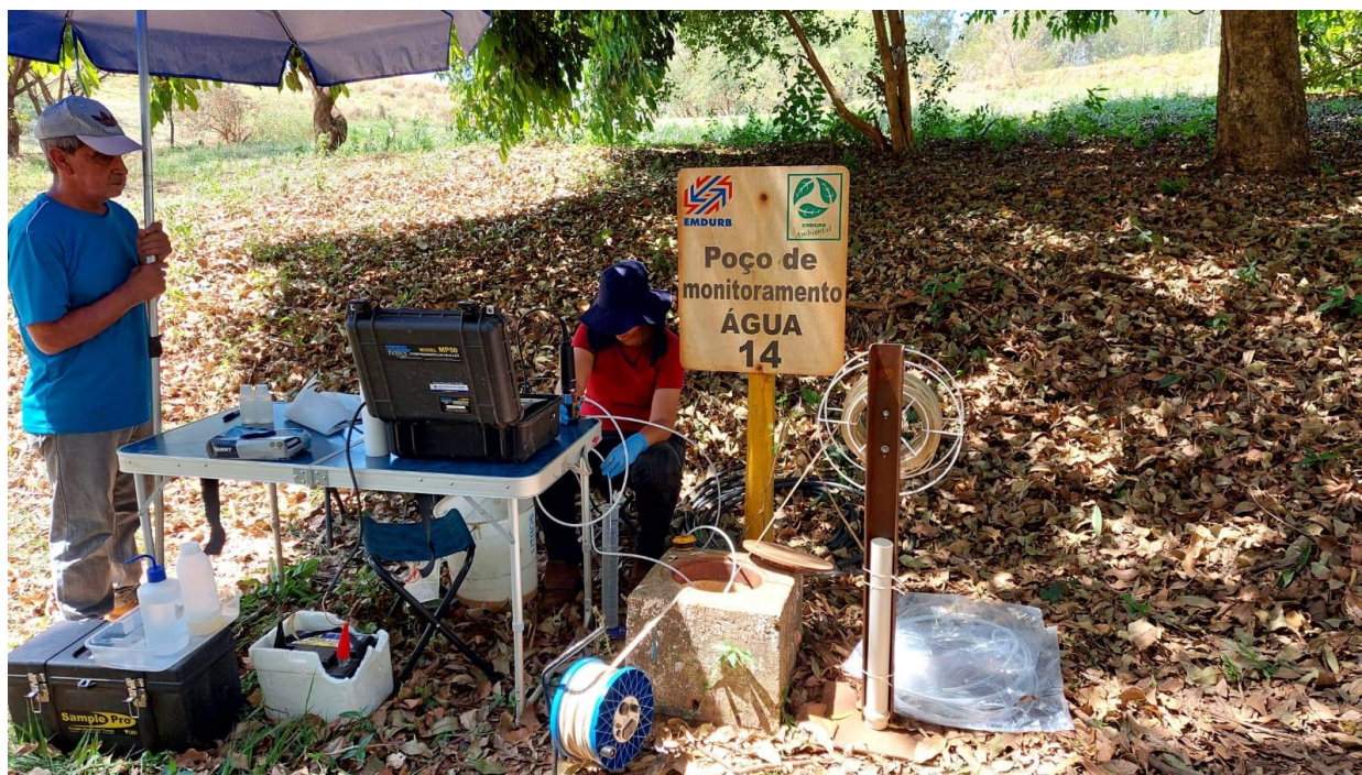
Figura 17: Amostragem do PP-14 no ARSUB a partir da técnica de baixa vazão.
